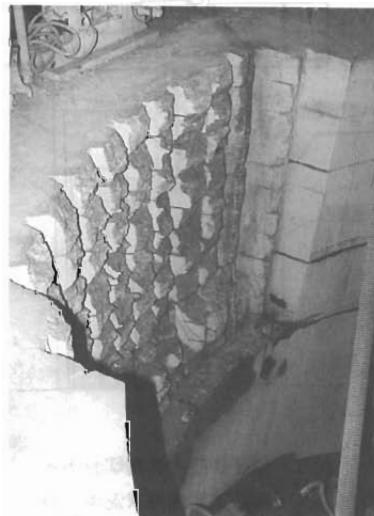
図 8 切削・剝離された試験体
