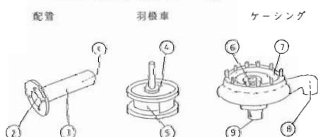
図3 スミヤ法の測定箇所
