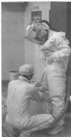
写真2  $\beta\gamma$ セルエアーラインスーツ ( $\beta\gamma$ ALS)
