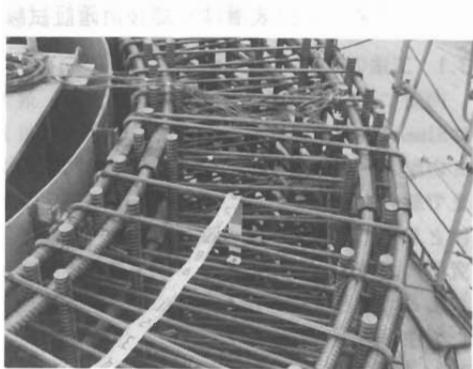
図 4 確証試験体配筋状況図
